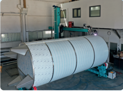
Tank dikey ve yatay dairesel kaynakların tamamı kolon bom otomatik kaynak makinamızda yapılmaktadır All vertical and horizontal circular welds are made on our column boom automatic welding machine for tanks.
